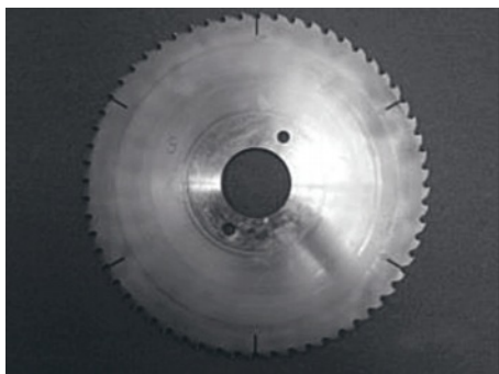
Диск LEUCODIA-Plattenaufteil-Kreissäge 380x4,8/3,5x75 Z60
