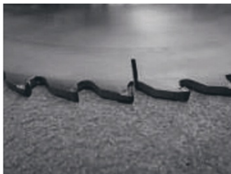
Ø 380 мм, с 60 твердосплавными зубьями
