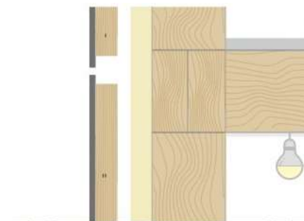
Рисунок 19: Соединение для горизонтального движения
