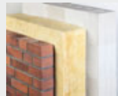
11,5 cm Vormauerziegel 20 cm Mineralwolle 24 cm Kalksandstein
